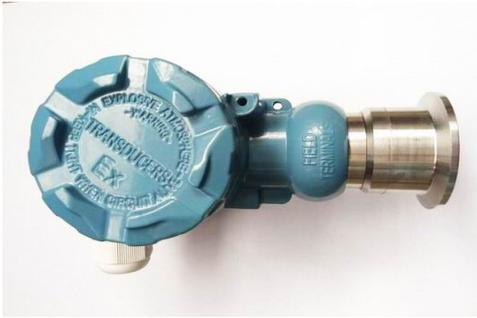
PTS517是一种抗腐蚀性强, 高稳定性, 高过载, 耐高温的变送器。其体积相对于普通的电容式变送器要小巧, 而且没有任何填充液, 不会有位置误差和泄露隐患, 而且其膜片为陶瓷, 耐腐蚀性, 抗磨损性均大大优于普通的不锈钢膜片电容式变送器。
