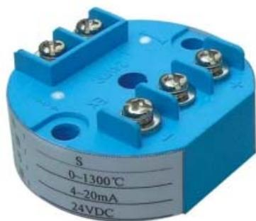
WB100 系列温度变送器适配 Pt100 或 Pt1000 铂热敏电阻，传感器外置，采用具有非线性补偿功能的三线制连接，导轨式和平面式安装两种，4~20mA 标准信号输出，可方便应用于各种工业现场的温度测量。
