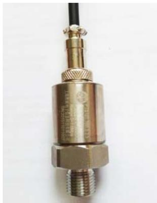
PTS101/100 系列是针对水泵/压缩机应用中实际性能的需要，在保证产品可靠性的前提下，通过优化外壳结构、生产工艺，进一步降低了成本。基于陶瓷压阻核心，与优化的变频干扰电路，通过严格的工艺流程批量生产。是一种可靠性高、体积小、成本低廉的产品。
