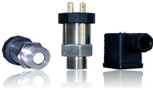
PTS200 采用平膜封装结构，其介质接触面可采用硬质陶瓷材料，不充任何液体，耐磨，易于清洗，不会堵塞。它主要用于粘稠液体、泥浆等介质的压力测量。相对于不锈钢波纹管充油型的同类产品有以下优点：
