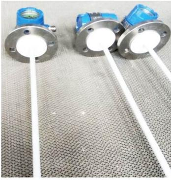
智能电容式液位计是一种可用于液体、固体、界面和测量的液位（物位）变送器。无可动部件，可靠性大的提高，不受水蒸汽，灰尘或冷凝的影响，具有长期运行稳定可靠，灵敏度高，线性度好，耐高温、耐高压等优点。
