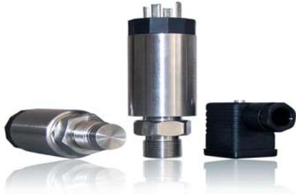
PTS150 系列压力变送器采用进口压阻敏感元件和独特的一体化弹性结构, 具有良好的稳定性和可靠性, 采用无机材料密封技术(铜密封或焊接密封), 避免了常规产品密封圈老化的问题。
