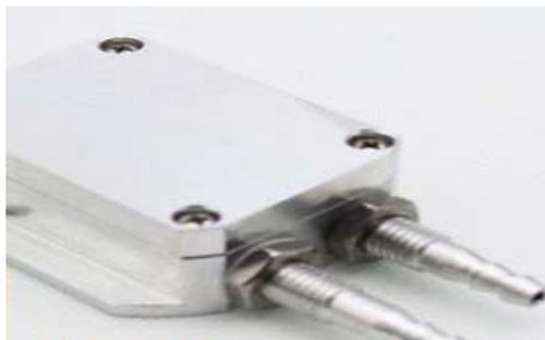
PTS320D 型差压变送器采用进口扩散硅芯体，专为测量小量程差压而设计，具有很好的稳定性和可靠性，精度高，抗冲击压力较好，适合测量各种非腐蚀的气体介质。
