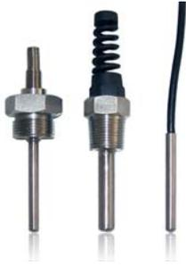
WT 系列温度传感器采用进口 PT100、PT1000 薄膜铂电阻或 CU50、CU100 铜电阻为敏感件，线性好，精度高，并且采用全金属密封结构和激光焊接工艺，灌注高绝缘导热弹性硅胶，抗振动，导热快，适合于液体气体的温度测量与控制。
