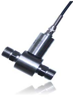
PTS310D 型差压变送器采用进口扩散硅芯体，专为测量小量程差压而设计，具有很好的稳定性和可靠性。精度高，抗冲击压力较好，适合测量各种与硅或者 316 不锈钢兼容的介质。通过改变压力连接的方式，可以很容易的测量负压，通过选择正负压复合测量方式可测量双向复合压力。
