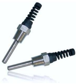
WK 系列温度开关采用双金属体，可靠性好，触点容量高，寿命长。并且采用全金属密封结构和激光焊接工艺，灌充高绝缘导热弹性硅胶，抗振动，导热快，适合于液体气体的温度控制。
